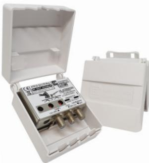
Il **Filtro LTE integrato**, sopprime i Canali Lte oltre il Canale 60 in DownLink di circa 15dB e in UpLink di circa 35dB. Nel caso in cui, l'interferenza Lte sia di intensità notevole, la soppressione delle frequenze può avvenire partendo anche dal Canale 58 o Canale 59.
