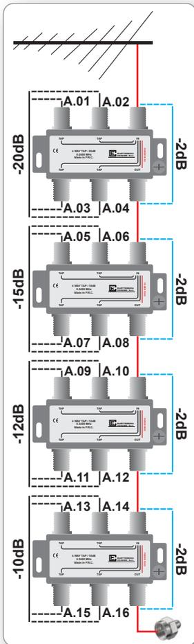
Il derivatore si utilizza per unire parti di un impianto d'antenna che abbiano un dislivello >5 dB. Un derivatore, ha sempre una uscita passante a bassa perdita (Circa 2,0 dB) con passaggio di tensione direzionale, ed un numero di uscite derivate (TAP). Il numero delle uscite derivate, può variare da una fino a quattro (a seconda del modello). I derivatori sono prodotti con differenti valori di attenuazione per le uscite derivate (generalmente dai 10 ai 20 dB con multipli di 2dB).
