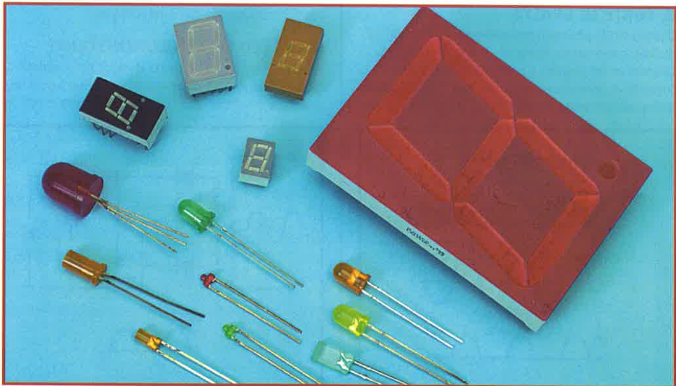
Differenti modelli di diodi luminescenti e display a 7 segmenti che li utilizzano.
