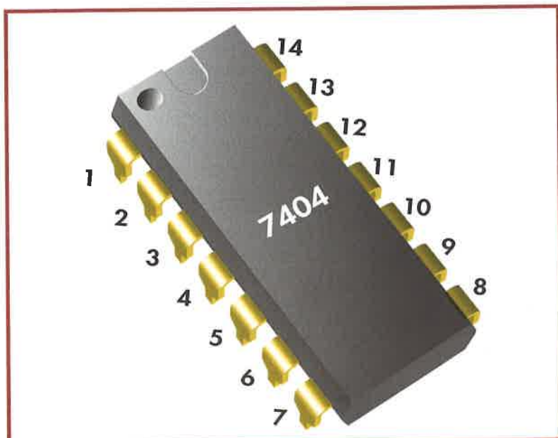
Contenitore del circuito integrato DIP, a doppia fila di piedini, la cui numerazione si determina seguendo il riferimento.
