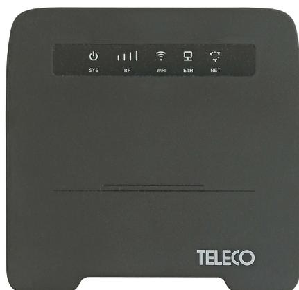
Il Router Portatile WFT 400 è dotato di una antenna interna in grado di ricevere tutti i segnali di buon livello GSM , 3G , 4G , LTE presenti nella zona in cui si trova , di trasformarli in una sorgente Wi-Fi ( tramite una Sim Card adeguata , non fornita) e di trasmettere su un'area di copertura di circa 30 mq.
