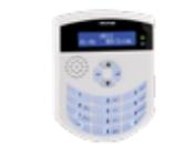
Tamper di protezione antiapertura ed antistrappo Buzzer Conforme alla norma CEI EN 50131- 1 Tipo: 04. Display: LCD retroilluminato. Colore: bianco. Ingressi programmabili: 1. Grado di protezione: IP40. Grado di sicurezza: 1. Classe ambientale: 2. Tensione nominale di alimentazione: 12Vcc ±5%. LED di segnalazione: 2. Grado protezione del contenitore: IP40. Contenitore: ABS. Dimensioni (L): 107mm. Dimensioni (A): 141mm. Dimensioni (P): 25mm.
