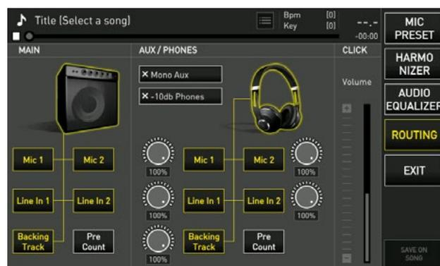
Nella pagina Routing si possono gestire tutti i parametri delle uscite Audio di Merish5.
