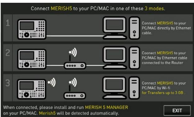
1. Collegarlo ad un PC tramite l'ingresso ETHERNET e trasferire i file e le cartelle tramite il software Merish5 Manager (PC o MAC) fornito.
