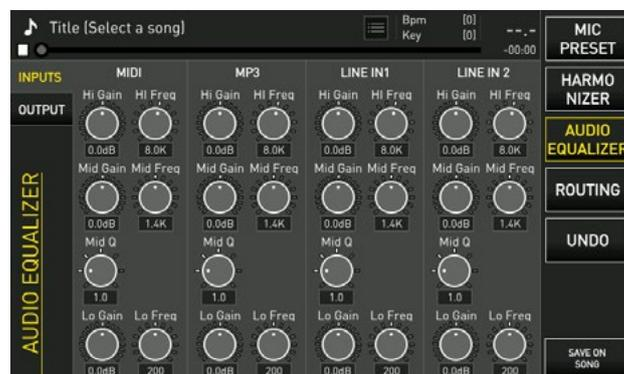
Nella sezione Audio Equalizer si può intervenire con potenti equalizzatori che hanno effetto sulla base musicale, sugli ingressi audio 1 e 2, e infine con un Equalizzatore a 10 bande che ha azione sul complesso dell'uscita audio di Merish5.
