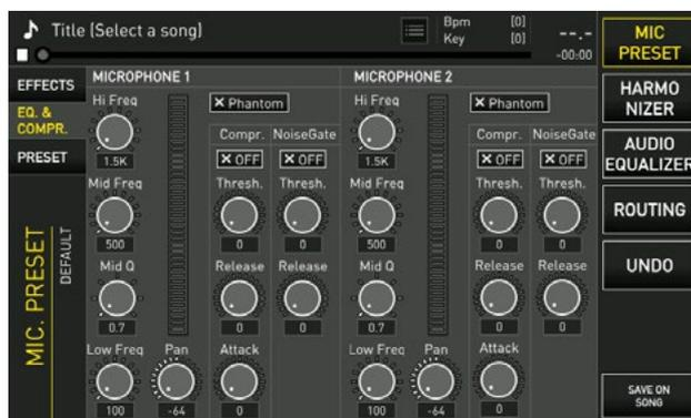
**X Phantom:** per attivare o disattivare alimentazione Phantom del Microfono.
