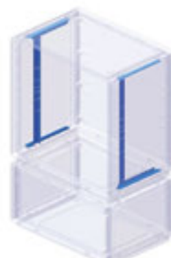
Installazione montanti su armadio completo di zoccolo riportato (non integrato)
